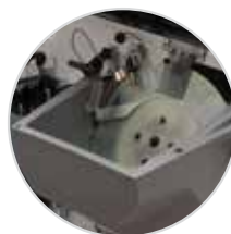
Un disque rotatif assure l'introduction des pièces une par une dans la goulotte des pièces
