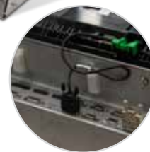
Le dongle contient le logiciel et la configuration destinée au module CAM est inclus
